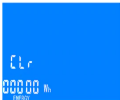
Obr. 9 Rozhraní vymazání stavu energie
