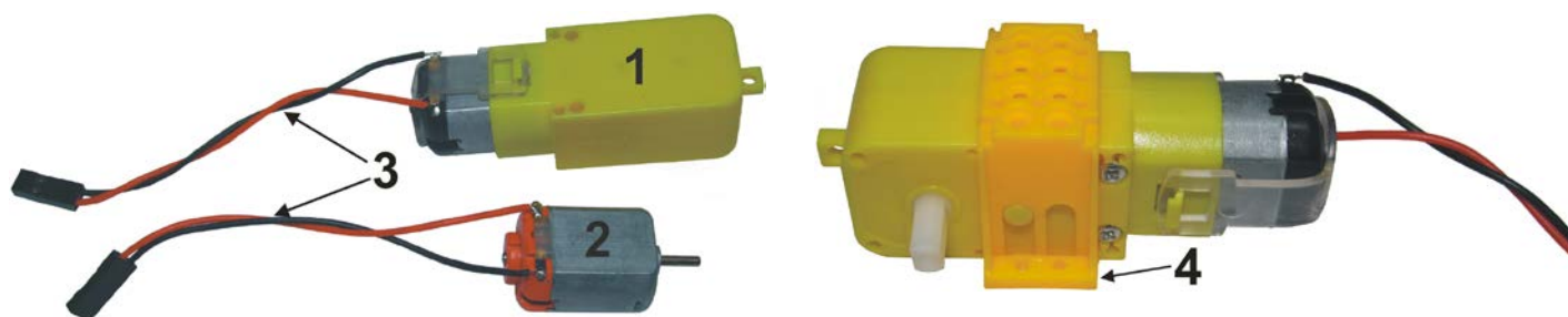
Obr. 2 zapájíme vývody motorků díly 1 až 3 - POZOR na polaritu! Obr. 3 nasadíme držák motoru bublifuku díl číslo 4
