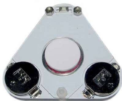
Obr. 7 Přišroubujeme vrchní díl plexi
