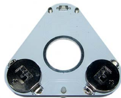
Obr. 3 Na plexi nasadíme plošný spoj a přitáhneme matickami
