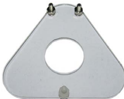
Obr. 2 Spodním plexi prostrčíme šroubky a přitáhneme matickami
