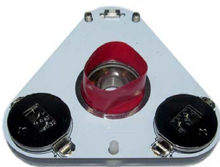
Obr. 5 Ložisko prostrčíme plošným spojem
