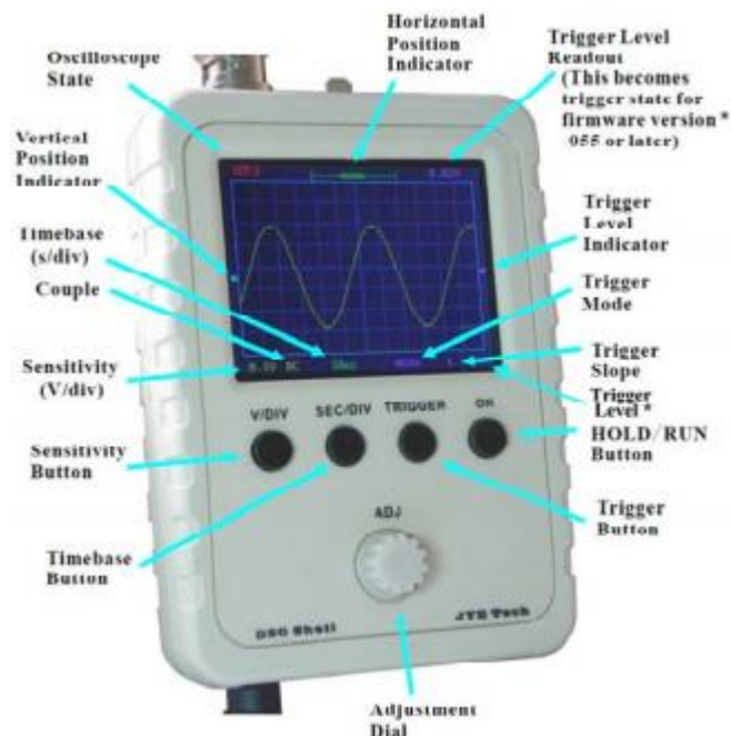
1, stav osciloskopu 2, indikátor vertikální polohy 3, Časová základna (s/dílek) 4, Připojení 5, Citlivost (V/dílek) 6, Tlačítko citlivosti 7, Tlačítko časové základny 8, Nastavení číselníku 9, Spouštěcí tlačítko 10, Stop/Start 11, Spouštěcí úroveň 12, Průběh spouštěče 13, mód spouštěče 14, Zobrazení úrovně spouštěče 15, Hodnota úrovně spouštěče 16, Horizontální pozice
