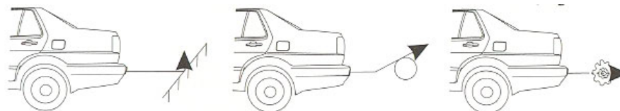
obr. 3 Objekty, které mohou způsobit chybnou detekci
