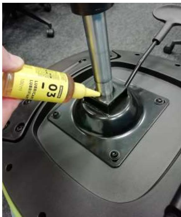
**1. Krok:** Židli otočíme a položíme na stůl. Do místa, kde se píst spojuje s mechanikou, nakapeme pár kapek oleje a necháme nejlépe 2 hodiny působit. Dojde k tomu, že olej postupně pronikne do hrdla mechaniky a uvolní nečistoty, které by mohly vytažení pístu ztížit.
